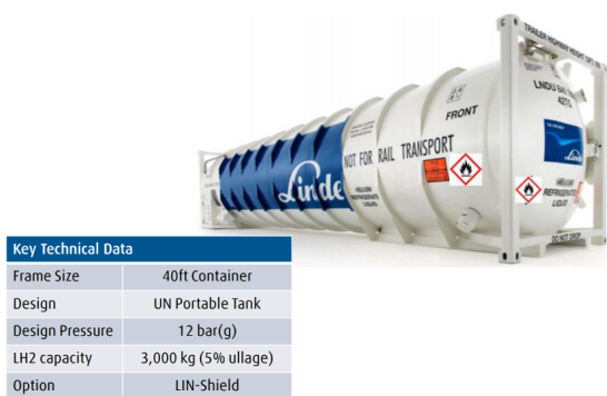
Fig. 5.16 : Hylics UN portable LH 2 tank (Linde 8 )
